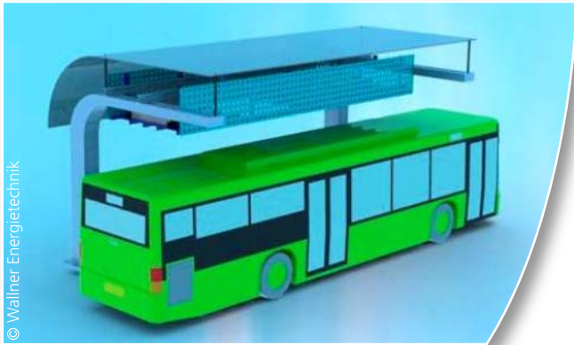
Bild 2: Das Batteriewechselsystem Change it ist gerade für intensiv genutzte Linien wirtschaftlich und ökologisch sinnvoll. Es wird nicht die eine Lösung geben, sondern das modulare Konzept ermöglicht die leichte Anpassung an die jeweiligen Anforderungen.
